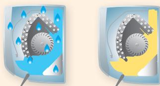
Cuando la unidad de aire acondicionado es apagada, el ventilador interno se activa y seca la humedad de la bobina, antes de apagarse automáticamente. En la gama Daiseikai, el sistema incluye ozono de baja densidad de efecto antiséptico.
