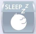
Presionando el botón CONFORT SLEEP se ajusta automáticamente el tiempo de operación, la temperatura y el caudal de aire.
