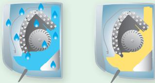
El sistema AvAnt esta dotado con función de auto limpieza, que reduce la humedad que causa la formación de moho en la unidad interior. Cuando el aire acondicionado es apagado, el ventilador interno se activa y seca la humedad de las bobinas antes de apagarse automáticamente.
